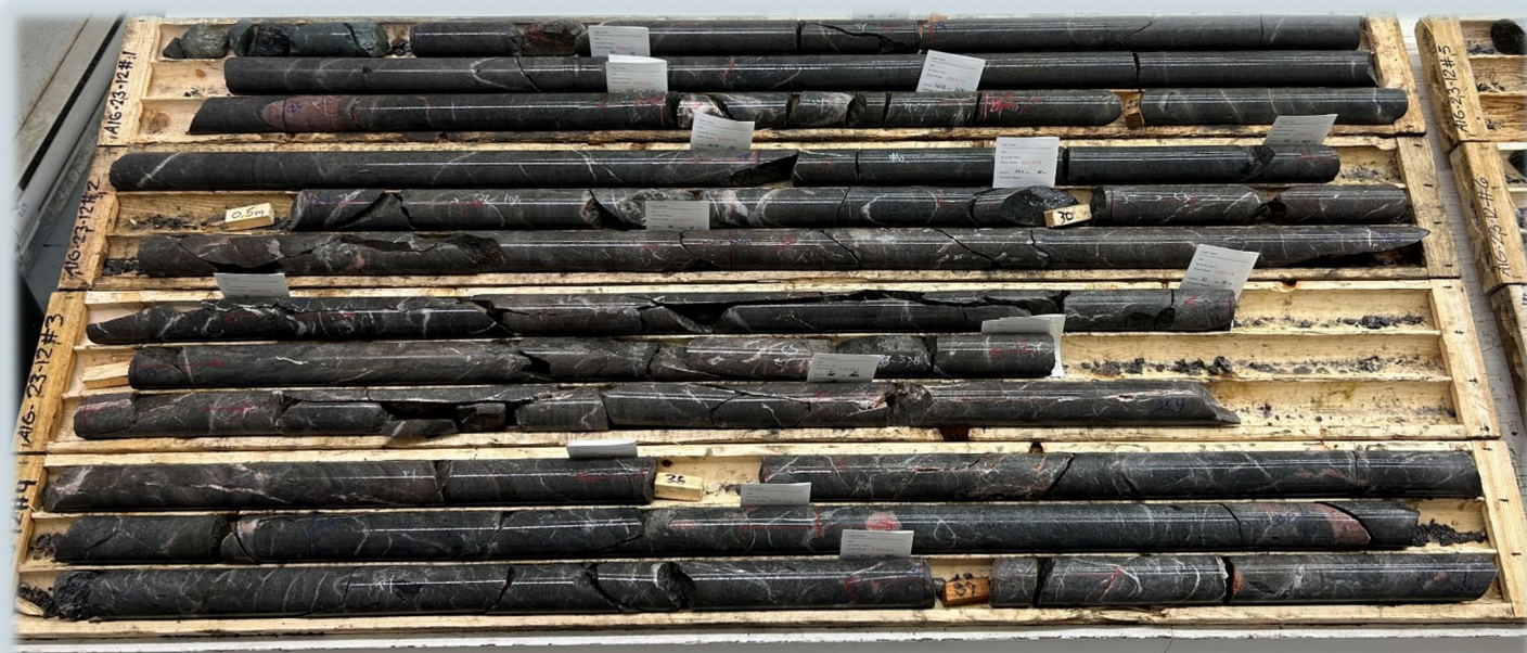
Lamprophyre carbonatisé et syénite filonienne. Pyrite rare
